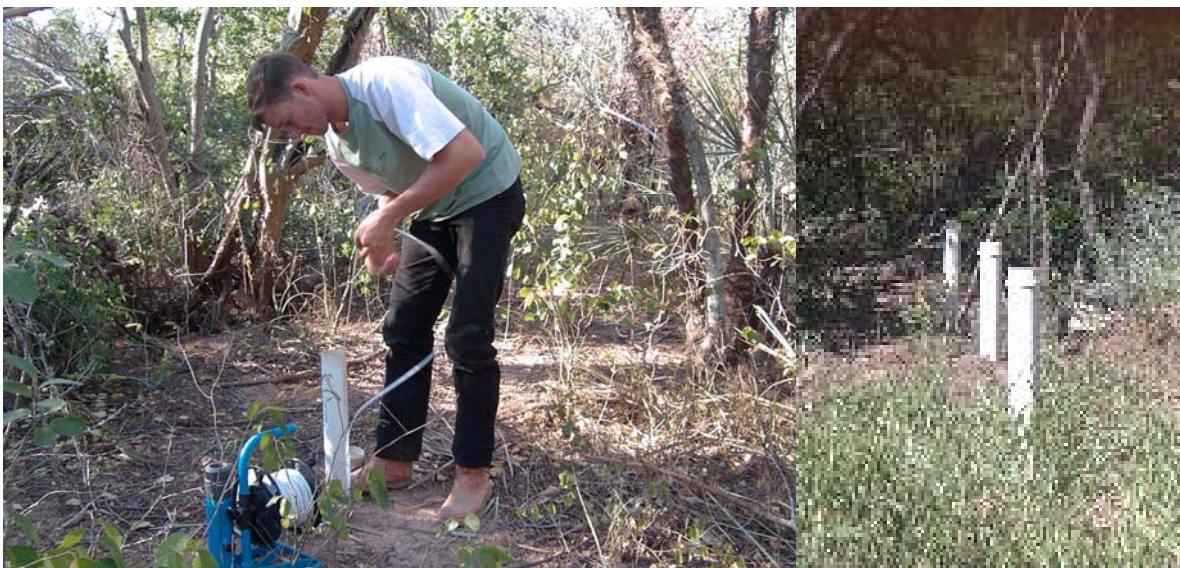
Fig. 4: Medición simultánea de la profundidad y conductividad de la napa y línea de tubos en la transición pastura-monte.
